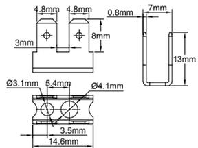
4 x 4,75 terminales Faston 90°. Al contar con un orificio de 3,1 y otro de 4,1, se pueden montar en los bloques de terminales de 2,5 mm<sup>2</sup> de PA66 de la serie BE y los bloques de terminales de cerámica de las series BCA y BCB. Atención: el uso de este accesorio podría reducir las distancias de aislamiento de los bloques de terminales.
