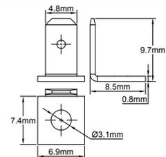
Lengüetas de 4,8 x 0,8, inclinadas 90°, se pueden montar en todos los terminales con tornillos M3.
