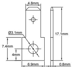
Lengüetas planas 4,8 x 0,8, se pueden montar en todos los terminales con tornillos M3.
