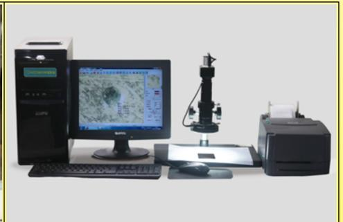
Medición con microscopio electrónico del diámetro de la marca (laboratorio Ultimheat)
