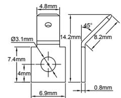
Lengüetas de 4,8 x 0,8, dobladas 135°, se pueden montar en todos los terminales con tornillos M3.
