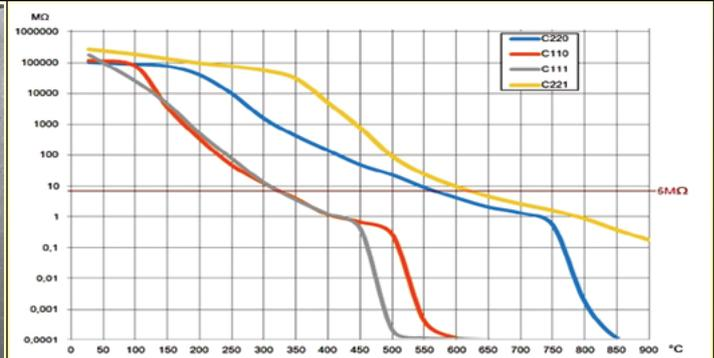
Curvas de variación de resistencia de aislamiento de bloques de terminales en función de su temperatura llevadas a cabo en distintos tipos de cerámica, (C110, C111, C220, C221) en un grosor de 2 mm. El valor 5MΩ es el límite normativo.
