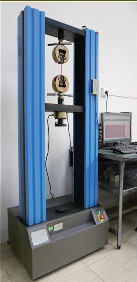
Banco de pruebas para ensayos de tracción
